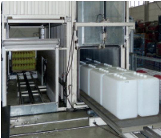
▲ In einem aufwändigen Verfahren erhalten Kunststofftanks eine zusätzliche Geruchssperre
